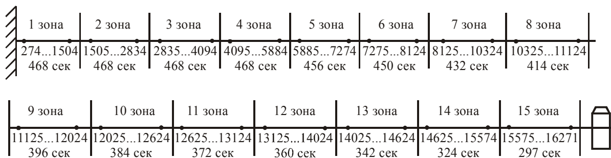
Рис.6.9.1. Структура дискового пространства накопителей MPE3xxxAH.
