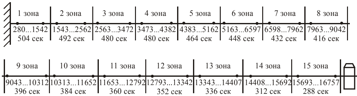
Рис.6.8.1. Структура дискового пространства накопителей MPE3xxxAT.
