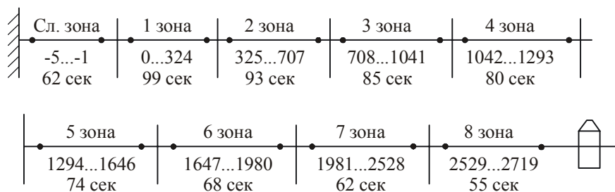
Рис. 5.4.2 Структура дискового пространства накопителей семейства WDAC2420
