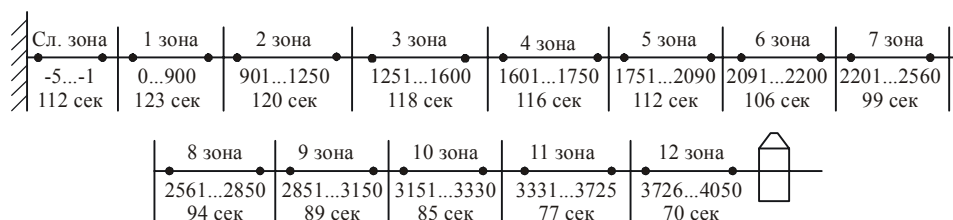
Рис. 5.5.2. Структура дискового пространства накопителей семейства WDAC2850
