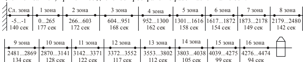
Рис. 5.4.2 Структура дискового пространства накопителей семейства WDAC21200
