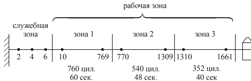
Рис.5.1.2. Структура дискового пространства накопителей семейства ST3144AT.
