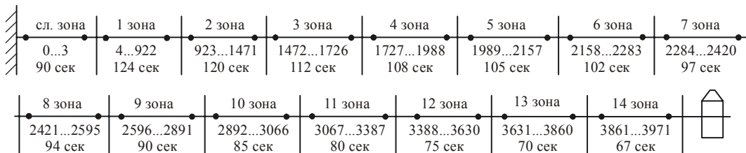
Рис.5.1.2. Структура дискового пространства накопителей семейства ST3850A.
