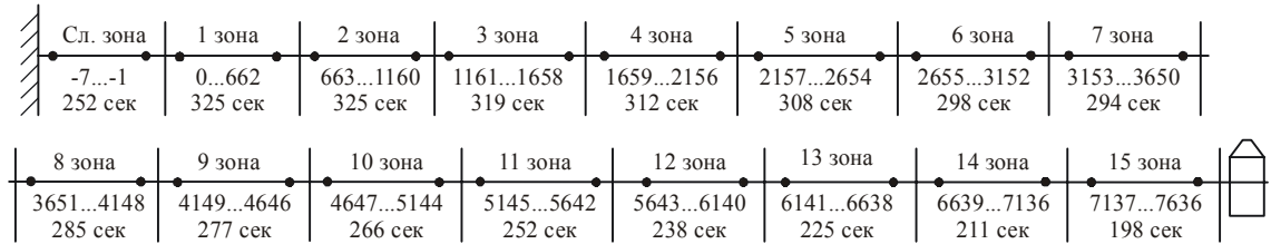
Рис.5.1.6. Структура дискового пространства SE.
