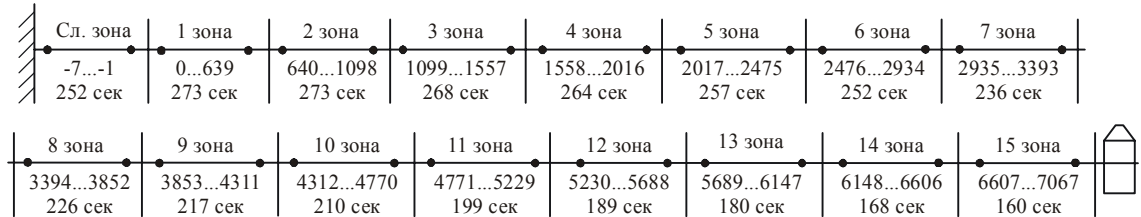
Рис.5.1.7. Структура дискового пространства ST.
